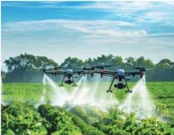
ଚିତ୍ର : ୭.୧୮: ଡ୍ରୋନ୍ (Drone) ଦ୍ୱାରା ଫସଲ ସ୍ୱାସ୍ଥ୍ୟର ଉନ୍ନତି ପାଇଁ ସାର ସିଞ୍ଚନ କରୁଥିବା ଡ୍ରୋନ୍ (Drone)
